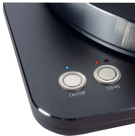
Zwei eingefasste Tasten steuern den Antrieb. Um den Riemen möglichst wenig zu belasten, läuft der Motor beim Start zweistufig an
