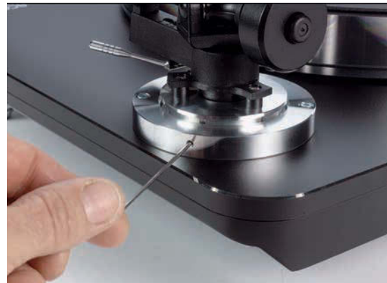
Eigentlich ist der Rega-Arm nicht in der Höhe verstellbar. Doch die nach Lösen einer Schraube verschiebbare Innenbasis macht's möglich
