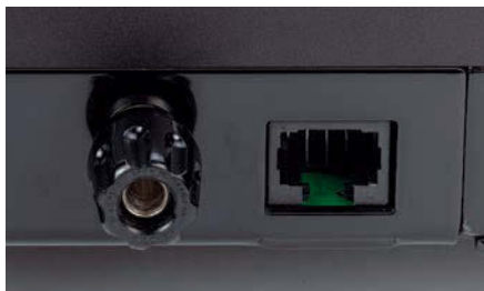
Die solide Erdungsklemme und der Anschluss fürs externe Netzteil. Nur für MM-Abtaster benötigen wir die Masseverbindung
